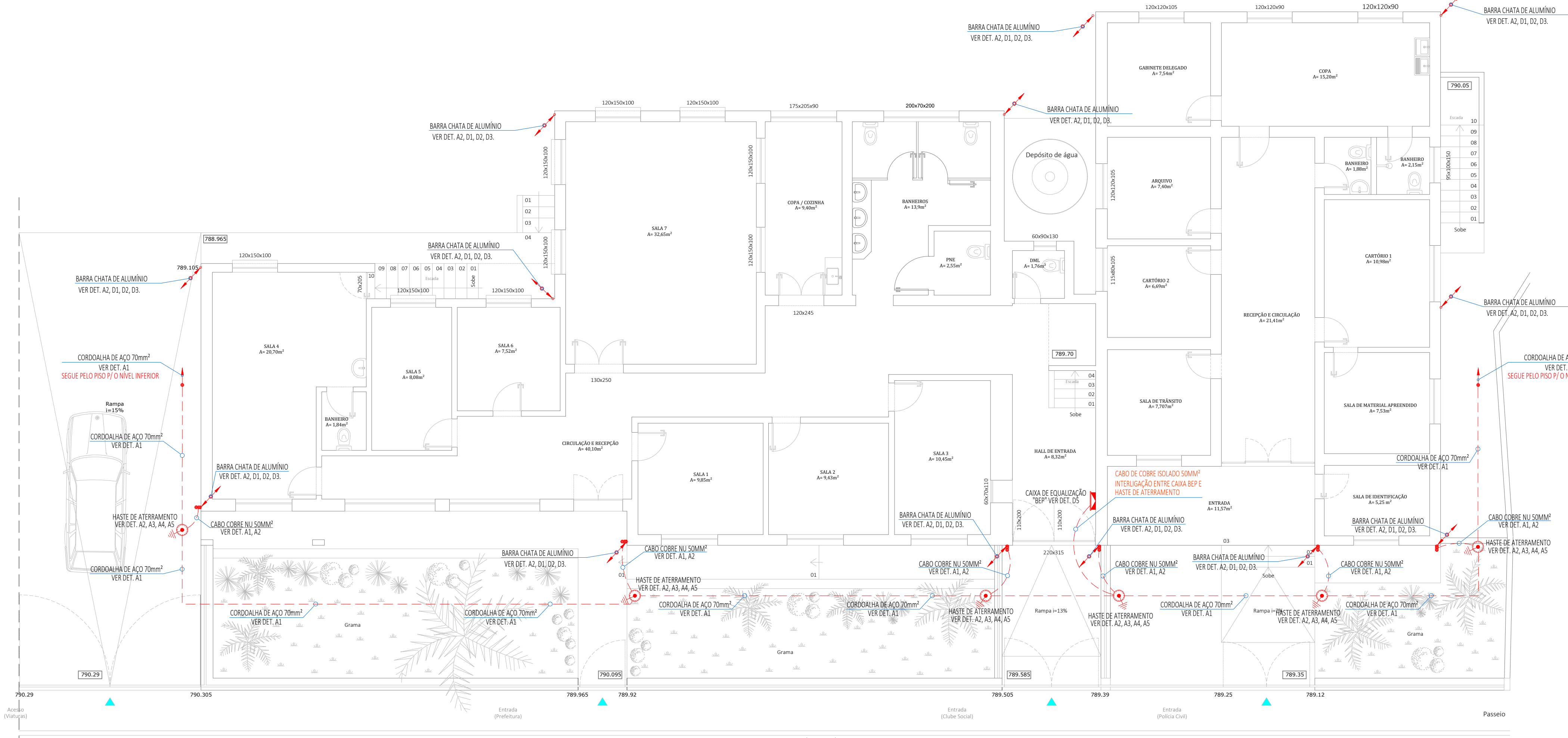
1º PAVIMENTO - DESCIDAS/ATERRAMENTO - SPDA ESCALA 1:75
